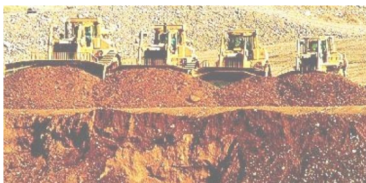
Rys. 4-80. Schemat zespołowej pracy 3 spycharek: 1 - objętość przemieszczanego urobku przy pracy indywidualnej, 2 - przy pracy w zespole z 3 spycharek
